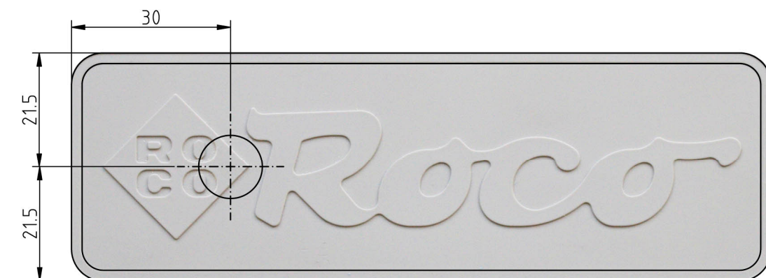
Abbildung 8: Position für die Öffnung für den Magnethalter
