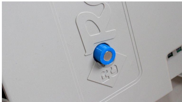
Abbildung 10: Kappe mit eingesetztem Magneten
